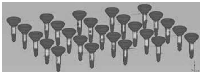
Hình 8. Lực dọc trong các cọc của khối TBF D1000 (giá trị lớn nhất N = 129 kN)
