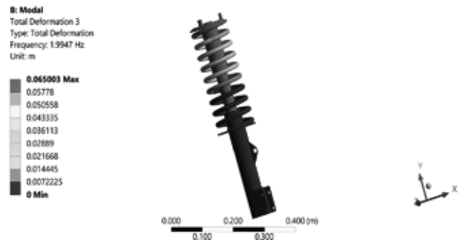
Hình 8. Hình thái dạng dao động tự nhiên bậc 3 của cụm treo
