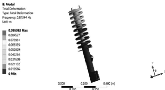
Hình 6. Hình thái dạng dao động tự nhiên bậc 1 của cụm treo
