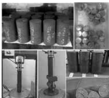
Hình 1. Bảo dưỡng mẫu thí nghiệm và thí nghiệm xác định cường độ mẫu
