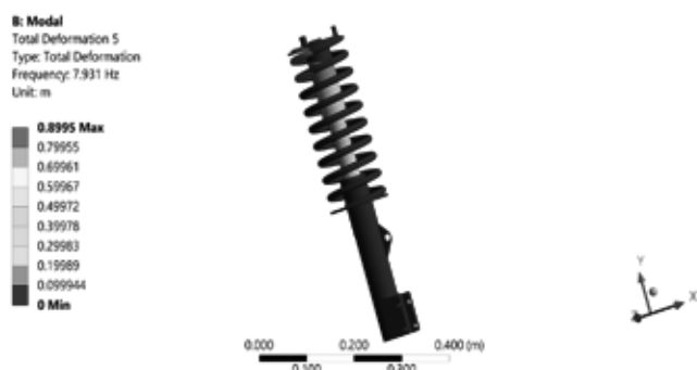
Hình 10. Hình thái dạng dao động tự nhiên bậc 5 của cụm treo
