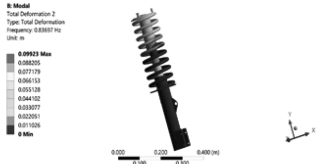
Hình 7. Hình thái dạng dao động tự nhiên bậc 2 của cụm treo
