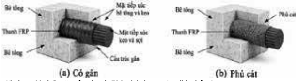
Hình 1. Các bề mặt của thanh FRP: (a) dạng gân, (b) phủ cát
