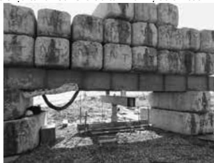
Hình 3. Thí nghiệm nén tĩnh hiện trường khối TBF
