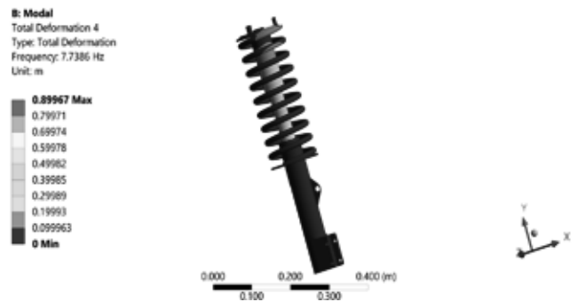
Hình 9. Hình thái dạng dao động tự nhiên bậc 4 của cụm treo
