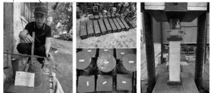
Hình 3. Thử nghiệm độ sụt của hỗn hợp bê tông, đúc mẫu và thí nghiệm cường độ nén mẫu bê tông
