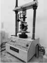
a) - Thí nghiệm nén Marshall
