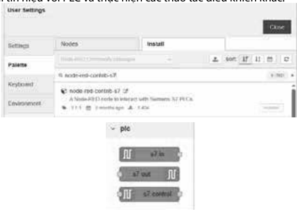
Hình 3. Giao tiếp S7-1500 qua thư viện node-red-contrib-s7
