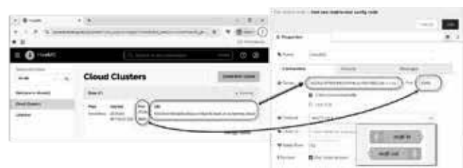
Hình 6. Liên kết "mqtt in" và "mqtt out" với server HiveMQ
