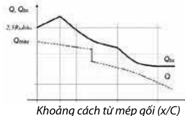
Hình 4. Ví dụ về biểu đồ lực cắt Q và Q_{bs} trên cùng hệ trục
