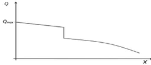
Hình 2. Ví dụ dạng biểu đồ lực cắt Q
