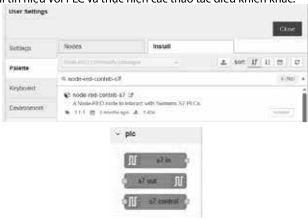
Hình 3. Giao tiếp S7-1500 qua thư viện node-red-contrib-s7
