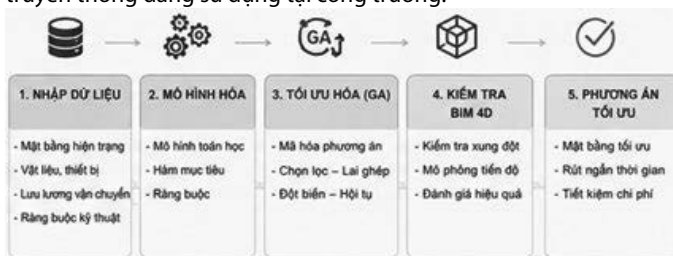
Hình 2. Quy trình tối ưu hóa (mô hình GA + BIM 4D)
