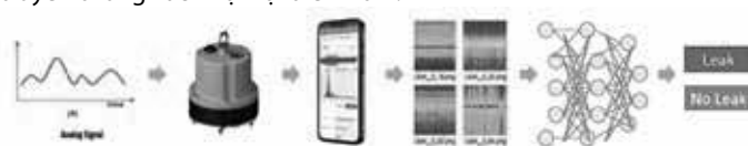
Hình 6. Sơ đồ nguyên lý hoạt động của Wi.Plat
