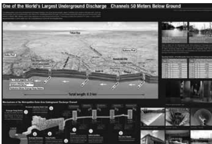
Hình 2. Sơ đồ tổng thể của hệ thống điều tiết ngầm G-Cans của Tokyo (Nhật Bản)
