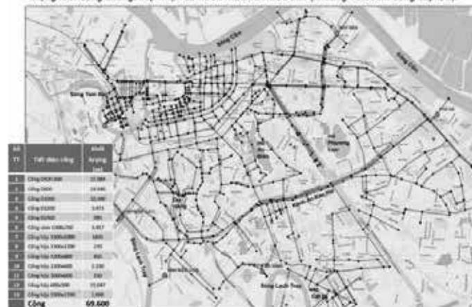
Mạng lưới cống chung, tiếp nhận cả nước mưa và nước thải (khoảng 70.000m cống cấp I, II).
