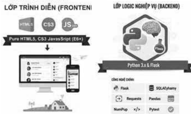
Hình 3. Lớp frontend và backend sử dụng HTML5, CSS3, JavaScript (ES6+), Python và Flask để đảm bảo tốc độ kết nối nhanh
