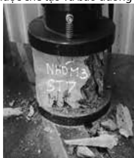
Hình 5. Thí nghiệm xác định cường độ chịu nén
