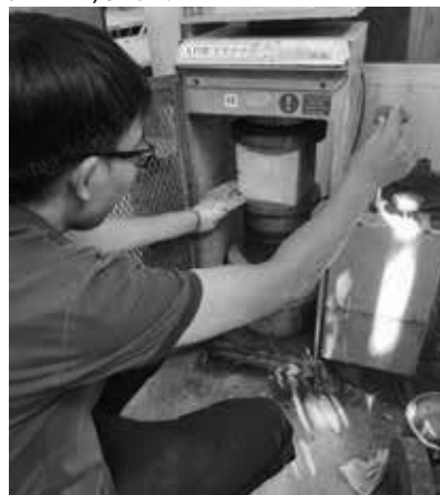
Hình 1. Thí nghiệm xác định R_n của BTXM
