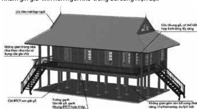
Hình 7. Hình thức nhà sàn xây mới
