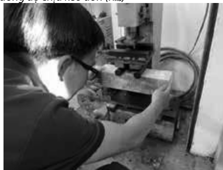
Hình 3. Thí nghiệm xác định R_{ku} của BTXM
