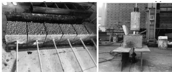
Hình 1. Thí nghiệm xác định ứng xử dính bám giữa cốt thanh GFRP và bê tông nhẹ [4]
