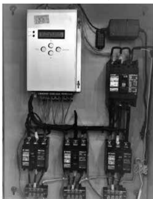
Hình 4. Mạch đo của thiết bị
