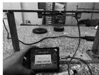
Hình 8. Bộ đọc tín hiệu cảm biến dây rung hãng DAS (Hàn Quốc) sử dụng trong thí nghiệm
