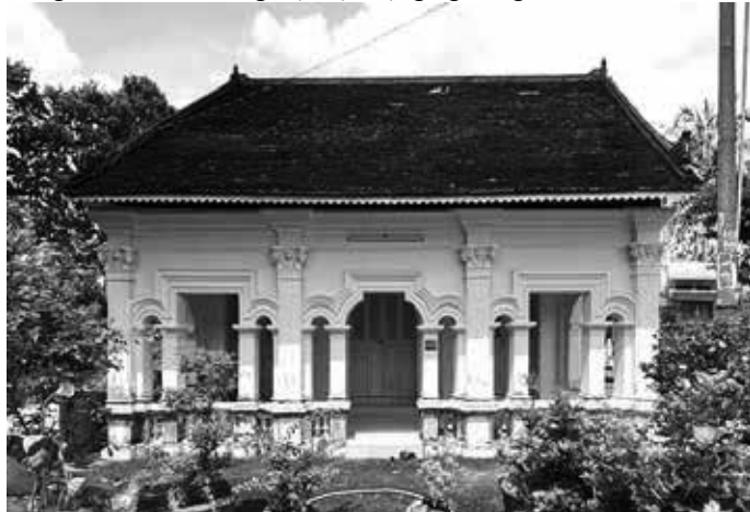
Hình 5. Tổ hợp 3 ngăn Palladian và đối xứng, nhân hình hóa trên mặt đứng nhà SD25
