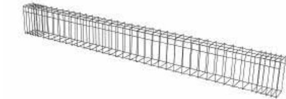
Hình 3. Mô hình phần tử cốt thép
