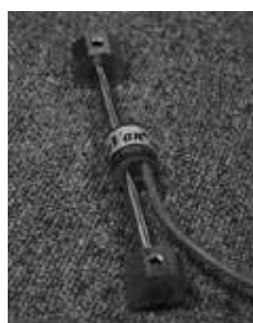
Hình 7. Cảm biến dây rung loại đo biến dạng GV-2405 hãng Geovan (Hàn Quốc)
