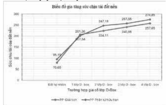
Hình 8. Biểu đồ gia tăng sức chịu tải của đất nền được gia cố D-Box
