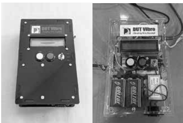
Hình 4. Bộ đọc tín hiệu cảm biến dây rung DUT Vibro
