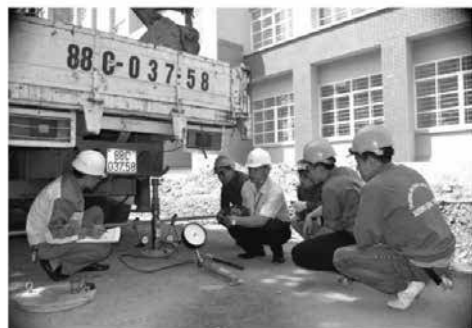
Hình 10. Thực hành đo mô-đun E đường thử nghiệm tại UTT tại cơ sở đào tạo Phú Thọ
