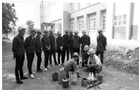
Hình 9. Thí nghiệm độ chặt nền đường thử nghiệm tại UTT tại cơ sở đào tạo Phú Thọ
